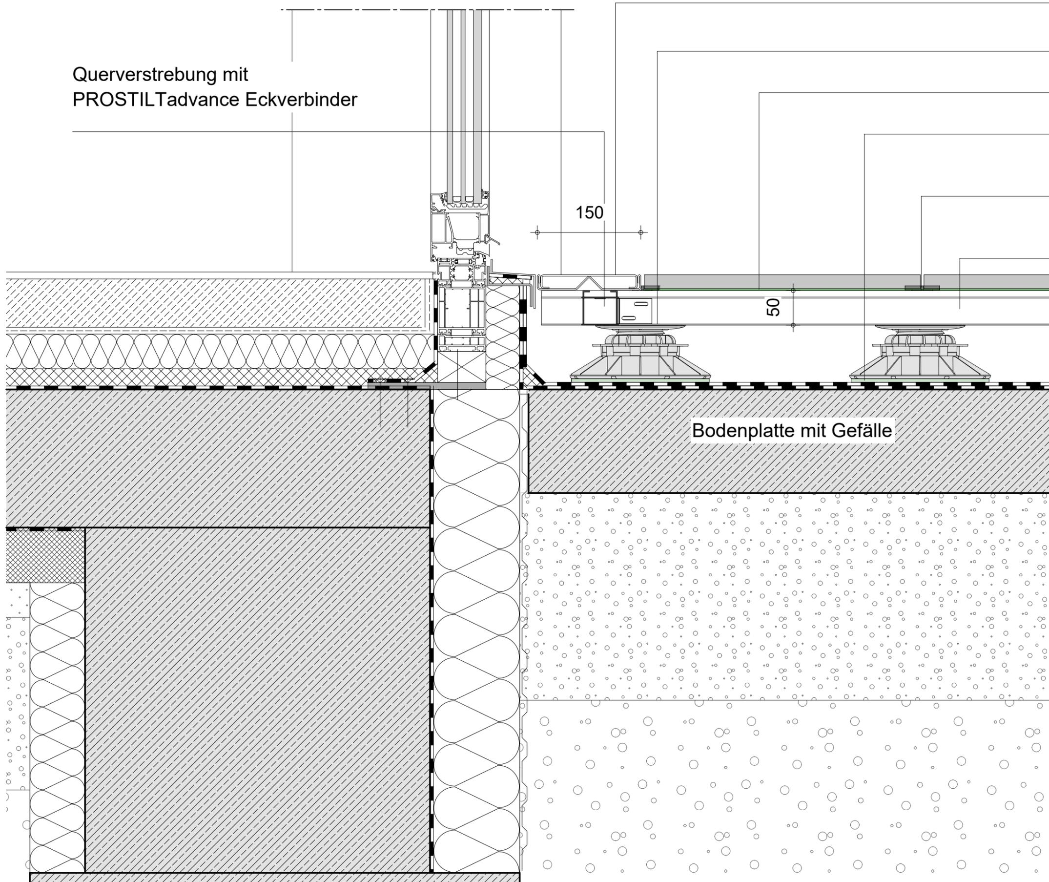
Bodenplatte mit Gefälle
