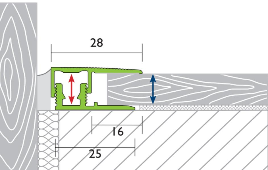
PROVARIOfclip Universal | Dimensions en mm
