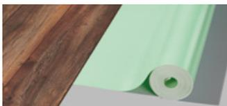
Verlegeunterlage aus feinporigem, geschlossenzelligen Polyolefin-Schaumstoff mit Grip-Oberfläche und integrierter Dampfsperre für Böden mit Click-Verbindung in normal bis stark genutzten Räumen.
