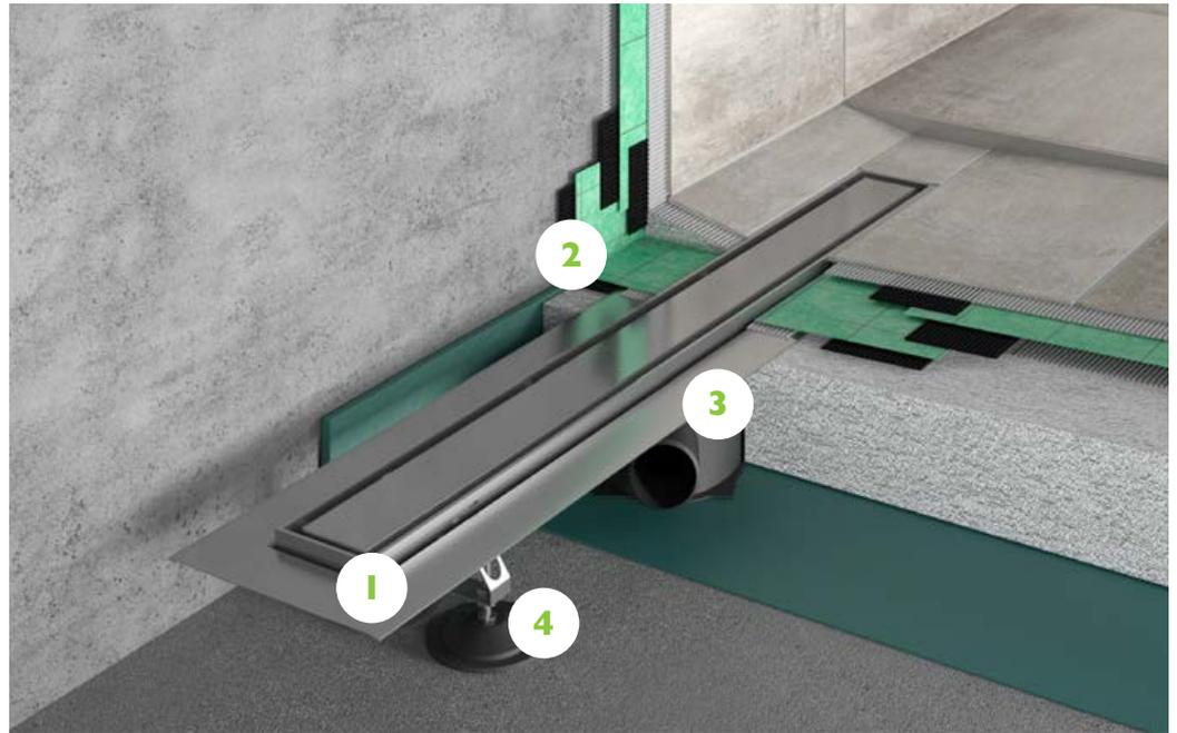
1. Mit der PROCHANNELs-line haben Sie bei der Wahl der Abdeckung vier Möglichkeiten, die PROCHANNEL Fliesenmulde und Designrost Steel (wie im Bild oben zu sehen) – mit beidseitiger Verwendung, sowie der PROCHANNEL Designrost Classic oder das PROCHANNELs-line Träger-element zur Ausbildung einer Schattenfuge.
