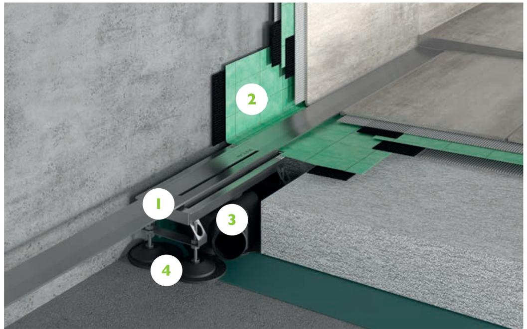
1. Rinne inkl. Duschprofil mit angeschweißtem s-line-Rahmen zur Höhenverstellung für Fliesenstärken von 10-17 mm. Der Profildeckel kann durch seine spezielle „Push-Funktion“ ohne Hilfsmittel mit der Hand entnommen werden. Aufgrund seiner technischen Konzeption und den gewählten Materialien ist er schnell und einfach hygienisch zu reinigen. Das innere Gefälle optimiert den Wasserabfluss, was zusätzlich zu einem Selbstreinigungseffekt führt.
