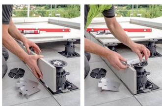
Poser la contremarche sur le clip inférieur PROSTILT et positionner et coller ensuite le clip supérieur sur le plateau d'appui. La contremarche est maintenue par le clip supérieur.
