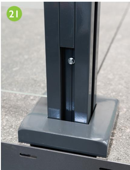
Zur besseren Stabilisierung können die Universalpfosten mit ein oder zwei Bohrschrauben 5,5 x 25 mm 6 TK am Pfostenhalter verschraubt werden.
