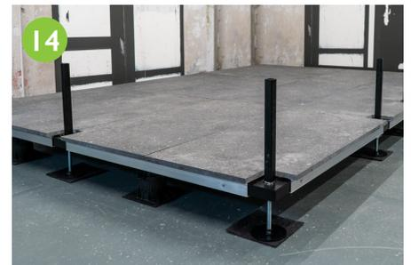
Bei Montage auf Abdichtbahnen Gummigranulatpads unter den Stellfüßen und den Gewindeplatten verwenden.
