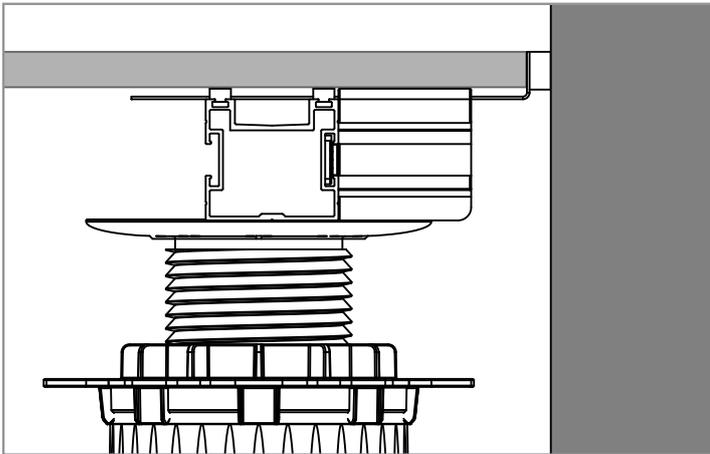
Zu Gebäudewänden oder aufragenden Bauteilen müssen zum Halten der letzten Plattenreihe Abstandshalter mit Neoprenpad eingebaut werden. Der Abstandshalter wird auf der Randabschlusskonsole so positioniert wie in der Skizze dargestellt und verschraubt. Die Randabschlusskonsole ist so zu drehen das die seitlichen Erhöhungen der Randabschlusskonsole mit dem Silence Strip des Basisprofils bündig ist.
