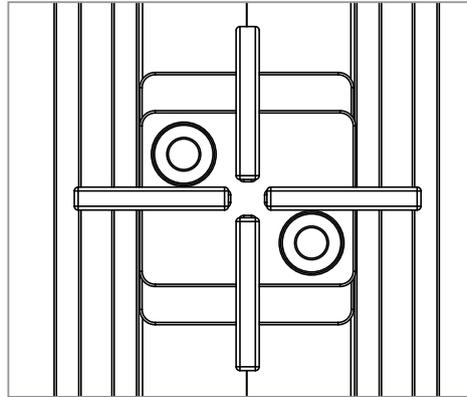
Das Fugenkreuz kann in zwei Positionen in die Basisplatte eingesteckt werden.
