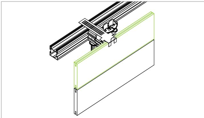
Sollten weitere Verblendungsdielen für die angedachte Verblendung nötig sein, können diese im Fugenbereich mit dem PROSTILTadvance 2.0 Clip-T an dem aufsteigenden Basisprofil verschraubt werden. Die oberste Verblendungsdielen wird mit den Halteklammern des Clip oben gehalten. Wenn die Verblendung richtig positioniert und ausgerichtet ist, die noch leicht angezogenen Schrauben in den Langlöchern des Clip oben anziehen.
