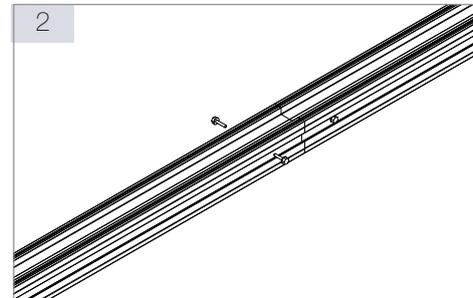
Der Conector L wird in den C-Nuten des Basisprofils mit jeweils 2 Bohrschrauben (6 KT Flansch 4,2 x 16 mm Art. Nr. 94338) fixiert.
