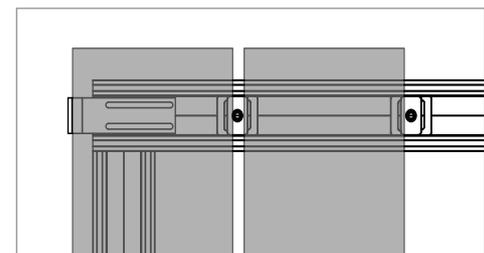
Bei Bedarf Anfangs- und Endhalter in das Profil einlegen auf die richtige Position bringen und mit Bohrschraube (6 KT Flansch 4,2 x 16 mm Art. Nr. 94338) verschrauben.
