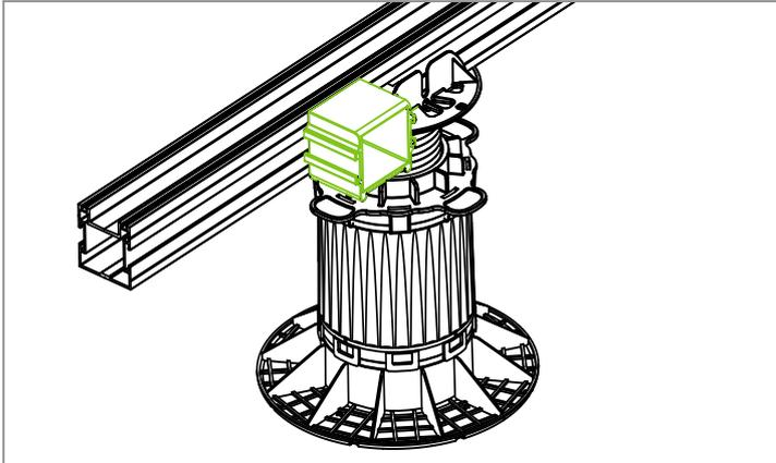
PROSTILTadvance 2.0 Randabschlusskonsole in die seitliche C-Nut des Basisprofils einführen (gleiche Vorgehensweise wie beim Querverbinder) und auf gewünschte Position schieben. Dabei ist zu achten, dass bei Verwendung von Profilen ohne Silence Strip die glatte Seite der Randabschlusskonsole oben mit dem Basisprofil bündig abschließt.
