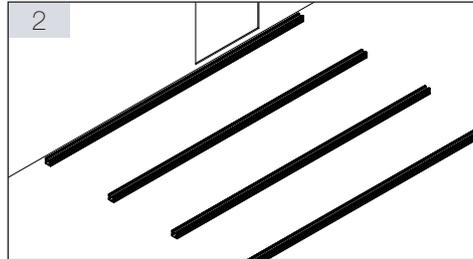
Wir empfehlen, zunächst alle Längsprofile vorzubereiten. Dazu Basisprofile auf die gewünschte Länge kürzen oder weitere Basisprofile mit dem PROSTILTadvance 2.0 Connector L ansetzen (siehe unten "Profilverbindungen")
