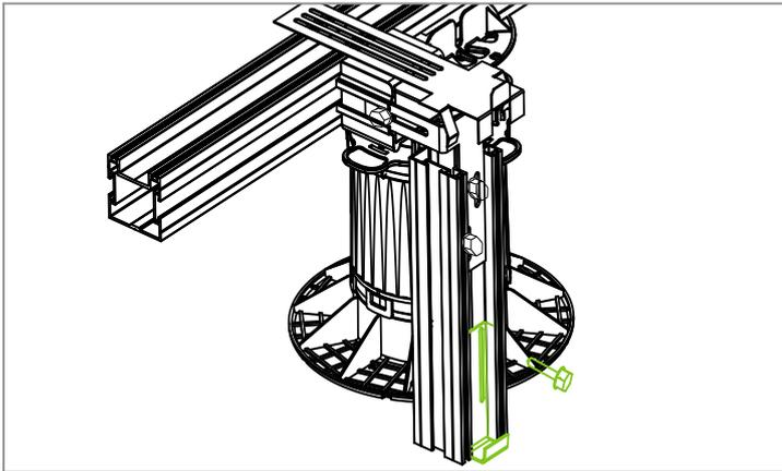
Bei der Verblendung mit z. B. Dielen mit Nut empfehlen wir die Verwendung des PRPSTILTadvance Anfangs- und Endhalter (Art. Nr. 78354). Dieser wird mittels Bohrschrauben am unteren Ende des Senkrechten Basisprofils verschraubt. Ebenso kann schon der PROSTILTadvance 2.0 Clip oben wie auf der Skizze dargestellt und auf der Randabschlusskonsole leicht verschraubt werden. Durch die Langlöcher des Clip oben kann im weiteren Montageverlauf noch die richtige Position des Clip oben justiert werden.
