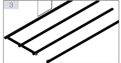
Ausschließend die seitlichen Querverstrebungen vorbereiten. Dazu Basisprofile kürzen und die PROSTILTadvance 2.0 Querverbinder in den richtigen Abständen (siehe S. 2 Feldbreite") montieren. (Montage PROSTILTadvance 2.0 Querverbinder siehe unten Profilverbindung)
