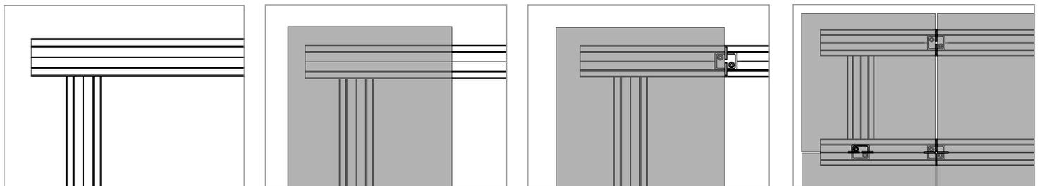
Erste Plattenreihe: Sofern die erste Plattenreihe nicht durch eine Randeinfassung wie PROSTILTadvance Fliesenanschlag Clip-X gegen Verrutschen gesichert ist, empfehlen wir, die Platten mit geeignetem Montagekleber auf der Unterkonstruktion zu befestigen.
