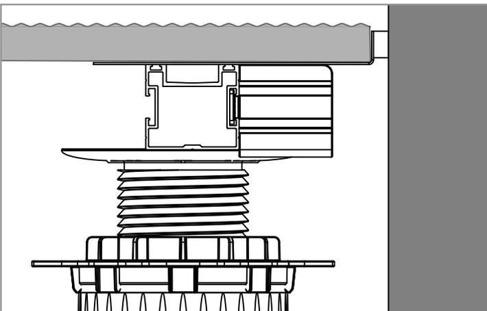
Zu Gebäudewänden oder aufragenden Bauteilen müssen zum Halten der letzten Dielenreihe Abstandshalter mit Neoprenpad eingebaut werden. Der Abstandshalter wird auf der Randabschlusskonsole so positioniert wie in der Skizze dargestellt und verschraubt. Die Randabschlusskonsole ist so zu drehen das die glatte Seite der Randabschlusskonsole mit der Oberkante des Basisprofils bündig ist.
