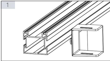
Den PROSTILTadvance 2.0 Querverbinder wie in der Skizze dargestellt (Bild1) in die C-Nut des Basisprofils einführen und um 90 Grad im Uhrzeigersinn verdrehen.
