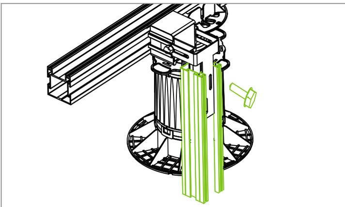
Nun kann ein auf Maß geschnittenes Basisprofilstück wie in der Skizze dargestellt mit dem nach unten zeigenden Haltestreifen des Verblendungshalters mit den Bohrschrauben verschraubt werden.
