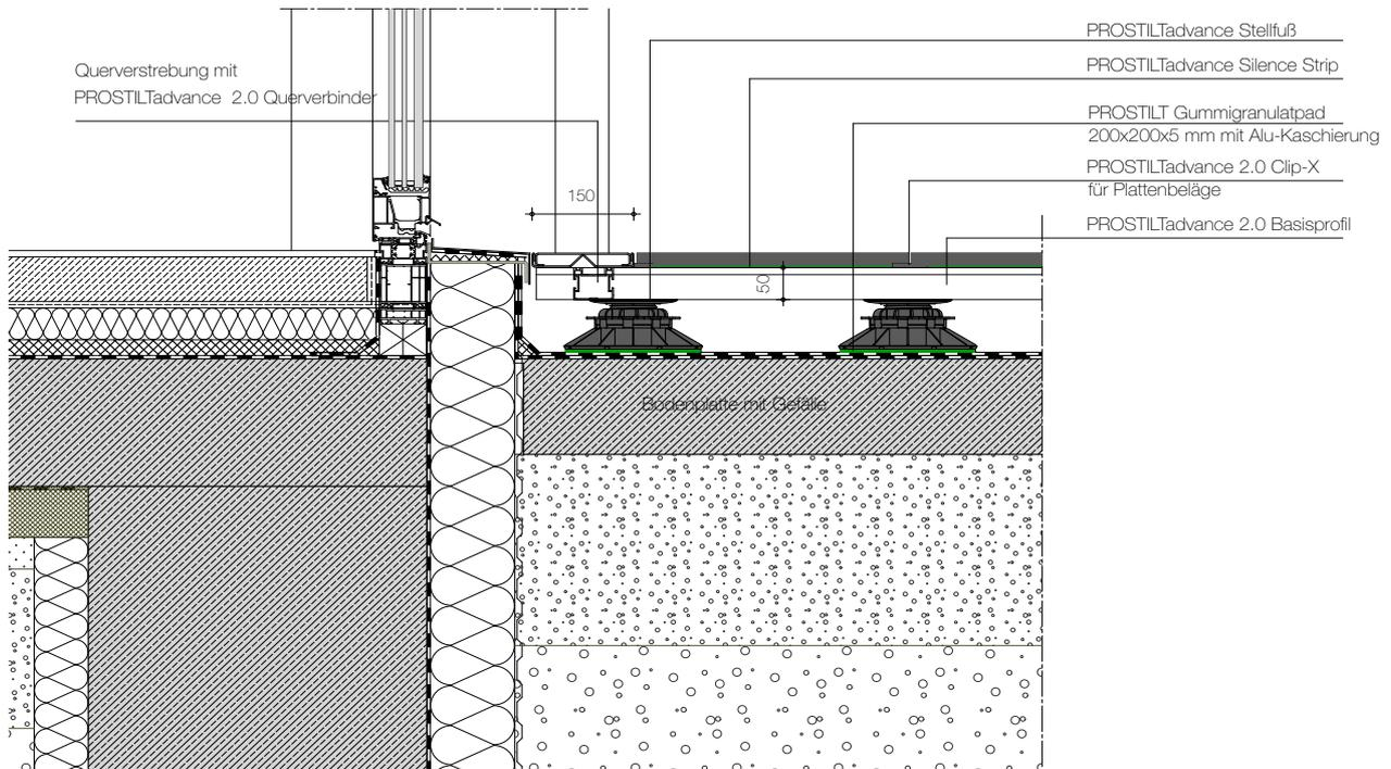
PROSTILTadvance 2.0 ALUMINIUM UNTERKONSTRUKTIONS-SYSTEM
