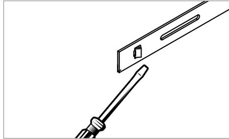
Mit der Schraubenzieherspitze in die kleinen Langlöcher des Verbinders eingreifen und die Führungsnasen aufhebeln.
