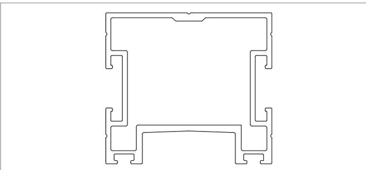
Für die sichtbare Verschraubung z. B. für Dielen ohne Nut empfehlen wir die dargestellte Profilausrichtung.
