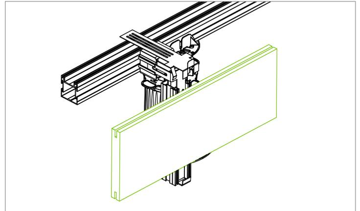
Wenn alle Randabschlusskonsolen mit Verblendungshaltern am Basisprofil positioniert sind, kann die erste Verblendungsdielen in den Anfangs- und Endalter eingesetzt werden.
