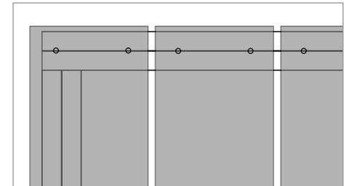
Die erste Dielen mittig auflegen und bei jedem Längsprofil mit zwei Schrauben befestigen (1x Abschlussprofil, 1x Längsprofil). Weitere Dielen auflegen und je Längsprofil mit zwei Schrauben befestigen. Dabei auf einen Fugenabstand von ca. 7 mm achten.
