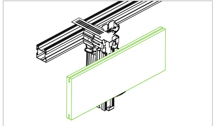
Wenn alle Randabschlusskonsolen mit Verblendungshaltern am Tragprofil positioniert sind, kann die erste Verblendungsdielen in den Anfangs- und Endhalter eingesetzt werden.
