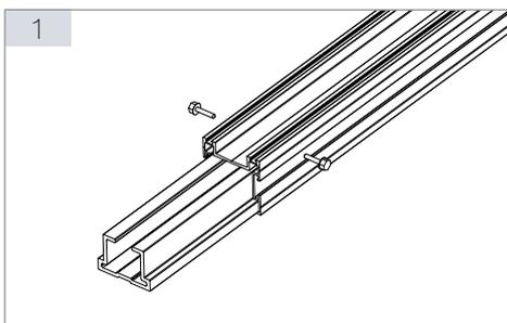
Um die Tragprofile in der Länge zu verbinden wird der PROSTILTadvance 2.0 L-Verbinder benötigt. Dazu wird der L-Verbinder bis ca. zur Hälfte wie in Bild 1 dargestellt in die kopfseitige Profilöffnung des Tragprofils eingeführt.
