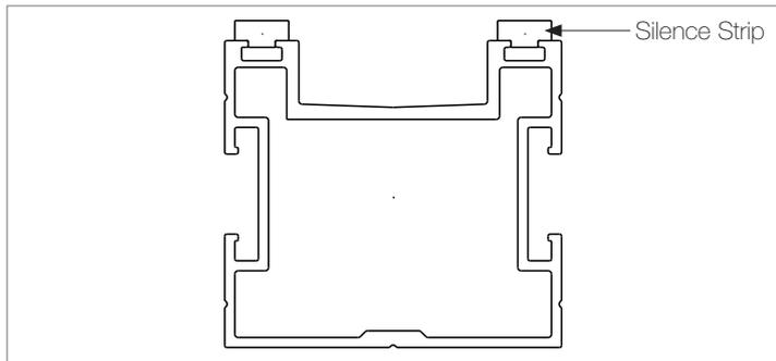
Der Silence wird zur Trittschallminderung und zur Verhinderung von Knirschgeräuschen unter Plattenbelägen aus z. B. Keramik, Naturstein oder Betonwerkstein dringend empfohlen.
