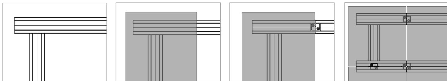
Erste Plattenreihe: Sofern die erste Plattenreihe nicht durch eine Randeinfassung wie PROSTILTadvance Fliesenanschlag Kreuz-Clip gegen Verrutschen gesichert ist, empfehlen wir, die Platten mit geeignetem Montagekleber auf der Unterkonstruktion zu befestigen.
