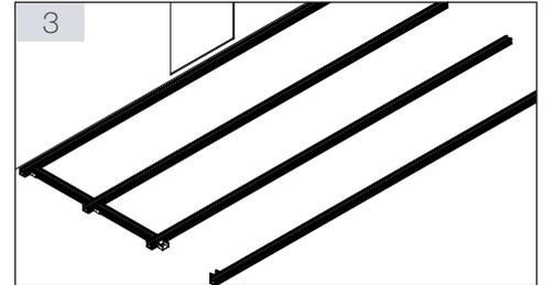
Ausschließend die seitlichen Querverstreben vorbereiten. Dazu Tragprofile kürzen und die PROSTILTadvance 2.0 Querverbinder in den richtigen Abständen (siehe S. 2 Feldbreite") montieren. (Montage PROSTILTadvance 2.0 Querverbinder siehe unten Profilverbindung)
