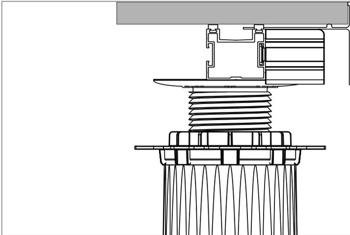
Für Keramik und Natursteinplatten bis 20 mm Stärke können auch unsere PROSTILTadvance 2.0 TOS-T Profile als Verblendung genutzt werden. Diese können wie in der Skizze dargestellt auf der Randabschlusskonsole aufgestützt und mittels Bohrschrauben verschraubt werden.
