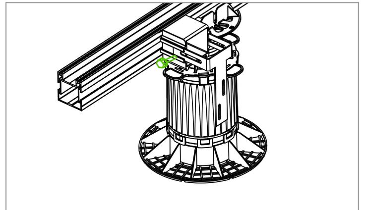
Den Verblendungshalter Senkrecht L durch die Langlöcher des Halters mit Bohrschraube (6 KT Flansch 4,2 x16 mm Art.Nr 94338) fixieren.
