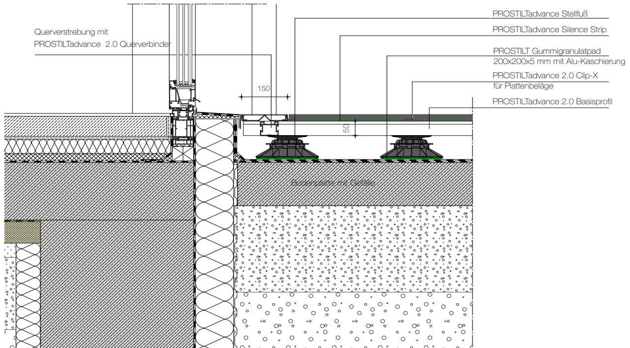
PROSTILTadvance 2.0 ALUMINIUM UNTERKONSTRUKTIONS-SYSTEM
