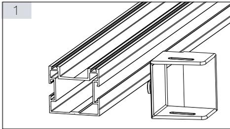
Den PROSTILTadvance 2.0 Querverbinder wie in der Skizze dargestellt (Bild1) in die C-Nut des Tragprofils einführen und um 90 Grad im Uhrzeigersinn verdrehen.
