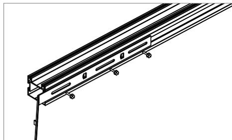
Den Verbinder an den Langlöchern mittels Bohrschraube (6 KT Flansch 4,2 x16 mm Art. Nr. 94338) fixieren.
