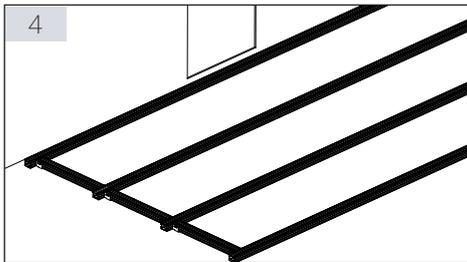
Nun können bei Bedarf weitere Querverbindungen in die Rahmenkonstruktion eingebaut werden. Die Rahmenkonstruktion kann nun auf Auflagepads oder Stelzlagerfüsse aufgesetzt und ausgerichtet werden.
