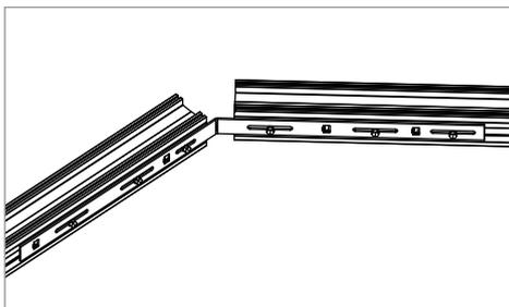
Der Verbinder kann nun mit dem angrenzenden Tragprofil wie in Bild 4 beschrieben verschraubt werden.
