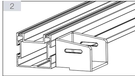
Der Querverbinder kann an jeder beliebigen Stelle der C Nut eingesetzt werden. Ein eventuelles Verschieben des Querverbinders ist auch im eingestezten Zustand in der C-Nut möglich.
