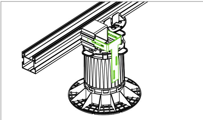
Die Verblendungshalter Senkrecht L kann durch verschieben in der C Nut der Randabschlusskonsole auf die gewünschte Position gebracht werden.
