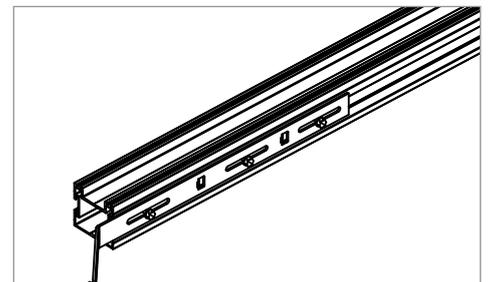
Bild 6 Die Position des Verbinders kann bei Bedarf durch lösen der Bohrschrauben im Langloch variiert werden.
