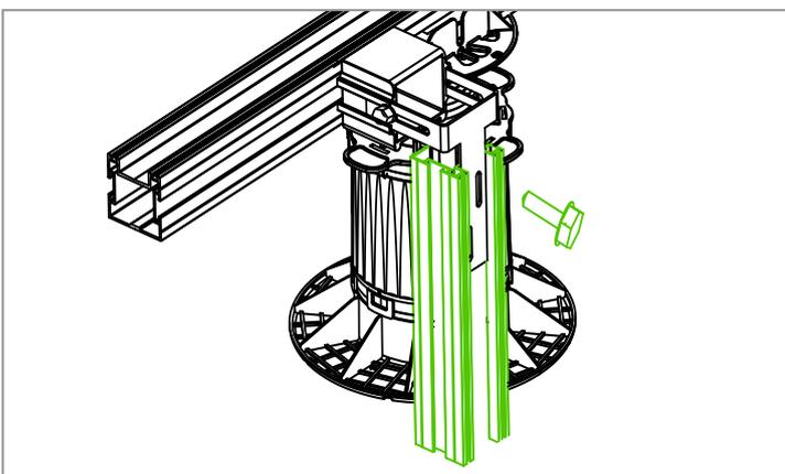
Nun kann ein auf Maß geschnittenes Tragprofilstück wie in der Skizze dargestellt mit dem nach unten zeigenden Haltestreifen des Verblendungshalters mit den Bohrschrauben verschraubt werden.
