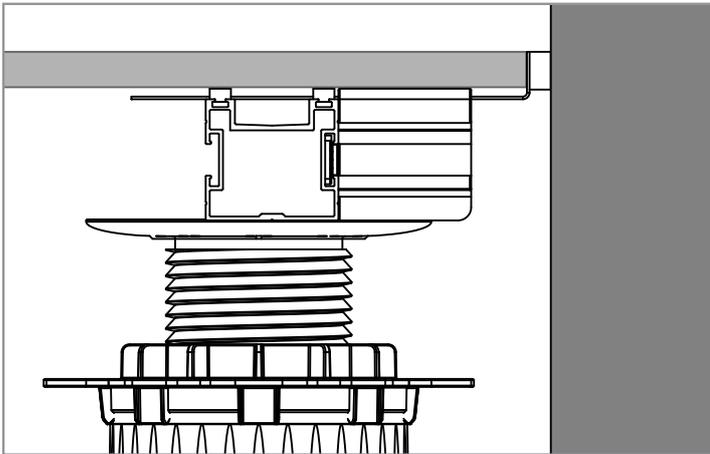
Zu Gebäudewänden oder aufragenden Bauteilen müssen zum Halten der letzten Plattenreihe Abstandshalter mit Neoprenpad eingebaut werden. Der Abstandshalter wird auf der Randabschlusskonsole so positioniert wie in der Skizze dargestellt und verschraubt. Die Randabschlusskonsole ist so zu drehen das die seitlichen Erhöhungen der Randabschlusskonsole mit dem Silence Strip des Tragprofils bündig ist.
