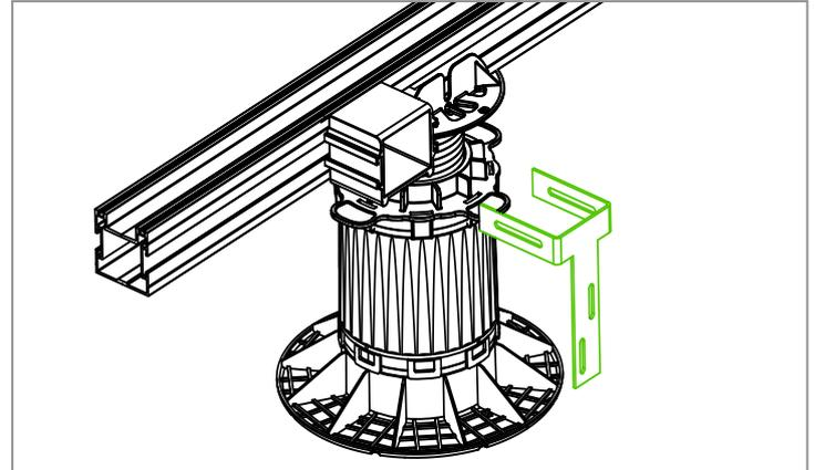
Nun kann der Verblendungshalter Senkrecht L in die C-Nuten der Randabschlusskonsole eingesteckt werden.
