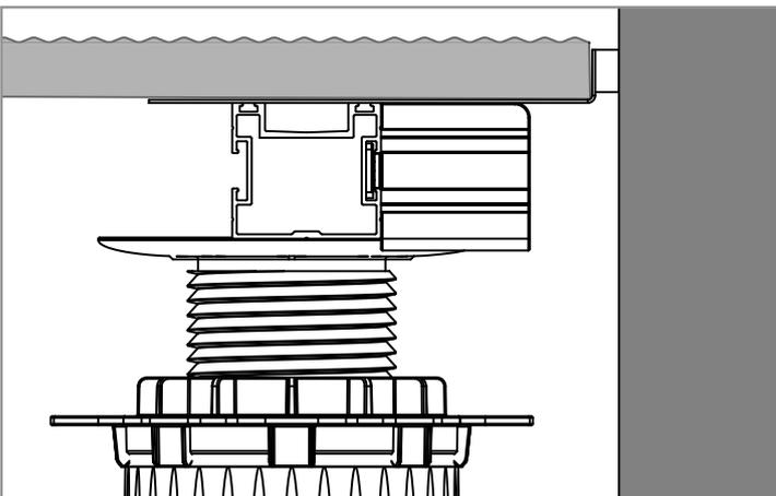
Zu Gebäudewänden oder aufragenden Bauteilen müssen zum Halten der letzten Dielenreihe Abstandshalter mit Neoprenpad eingebaut werden. Der Abstandshalter wird auf der Randabschlusskonsole so positioniert wie in der Skizze dargestellt und verschraubt. Die Randabschlusskonsole ist so zu drehen das die glatte Seite der Randabschlusskonsole mit der Oberkante des Tragprofils bündig ist.
