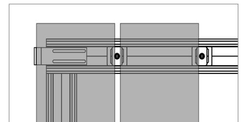
Bei Bedarf Anfangs- und Endhalter in das Profil einlegen auf die richtige Position bringen und mit Bohrschraube (6 KT Flansch 4,2 x 16 mm Art. Nr. 94338) verschrauben.
