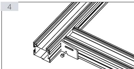
Das Querverbindungsprofil wird nun an den seitlichen Langlöchern des Querverbinders mittels Bohrschraube (6 KT Flansch 4,2 x 16 mm Art. Nr. 94338) fixiert.
