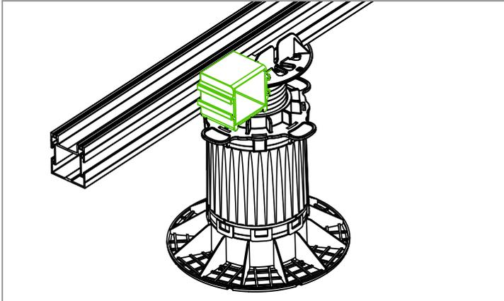
PROSTILTadvance 2.0 Randabschlusskonsole in die seitliche C-Nut des Tragprofils einführen (gleiche Vorgehensweise wie beim Querverbinder) und auf gewünschte Position schieben. Dabei ist zu achten, dass bei Verwendung von Profilen ohne Silence Strip die glatte Seite der Randabschlusskonsole oben mit dem Tragprofil bündig abschließt.
