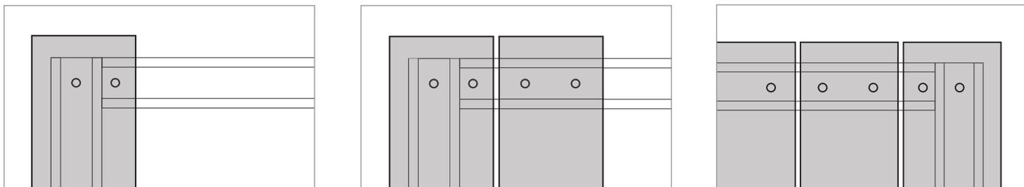
Placez la première planche au centre et vissez-la sur chaque profilé longitudinal à l'aide de deux vis (1x sur le profilé de finition, 1x sur le profilé longitudinal). Posez les autres planches, et fixez-les avec deux vis sur chaque profilé longitudinal. Veillez à laisser un joint d'environ 7 mm.
