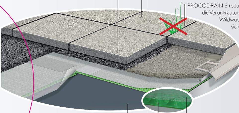
Die Lösung heißt PROCODRAIN S, die kapillarbrechende Drainageschicht für auf lose Schüttungen verlegte Beläge. Erhöhen Sie die Lebensdauer und erhalten Sie das schöne Aussehen Ihrer Außenbeläge mit PROCODRAIN S.
