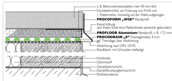
PROCODRAIN S für lose Schüttungen wird auf der Abdichtungslage ausgelegt. Darüber wird die lose Schüttung (hier Basaltsplitt) in der erforderlichen Höhe und der eigentliche Belag aufgebracht. Das PROCOFORM Randprofil „WSE“ schließt die Konstruktion nach außen ab.
