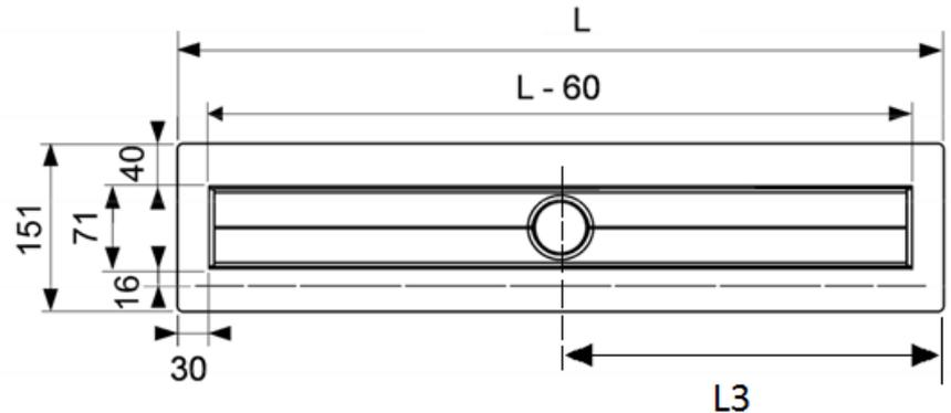
Ab 1500 mm Länge müssen mindestens 2 Abläufe eingebaut sein
